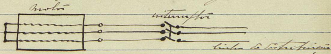
Para motores maiores evita-se este inconveniente, empregando os aneis d'arranque, segundo o schema
